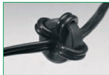
Bild 3: Die mit einem Ferrit präparierte Messleitung
